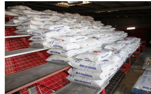
Prueba de carga de graderío.
